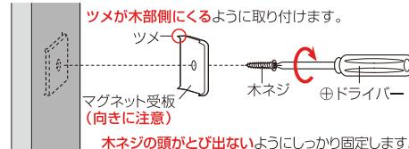
**△注意** マグネット受板の向きを間違えますと木ネジの頭が飛び出で、ツメが外向きになり、非常に危険です。必ず、マグネット受板の向きを確認し、正しい向きで取り付けてください。また、マグネット受板のツメはとがっていますのでケガをしない様、取り扱いには十分お気を付けてください。
