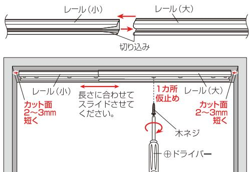
② レールを仮止めしたネジを中心に回転させ、ドア本体についている**取手がレール(小)側にくるように**して、レールにドア本体をセットしてください。セット完了後、ドア本体をレール全体の中央付近(木ネジで仮止めした位置)に寄せてください。
