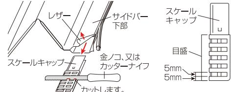
③ カットされたスケールキャップをサイドバーに再びしっかりと差し込んだ後、スケールキャップのカット部分の寸法に合わせて、サイドカバーを金ノコ等でカットしてください。
