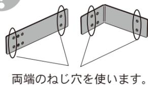
Point 各連結プレートは脚のセンターV溝に合わせてねじ止めます。
